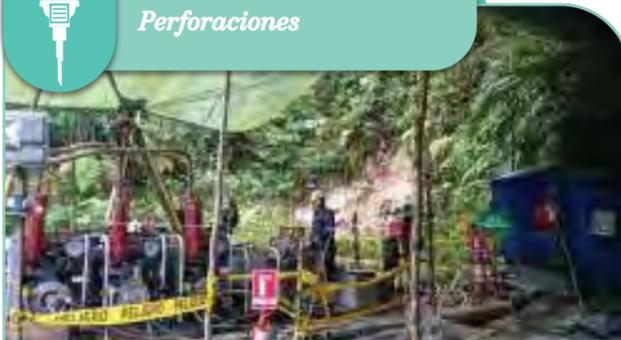
En Fruta del Norte se han realizado perforaciones de hasta 1.200 metros de profundidad para definir la forma y dimensiones del depósito mineral. Para descubrir FDN, se desarrollaron 553 pozos, que equivalen a 184.789 metros de perforación.
